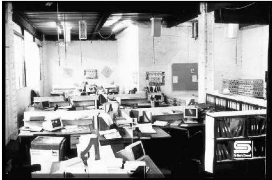
*Bild 4 Brandabschnitt mit realen Brandlasten vor der Zündung (Foto: British Steel)*
