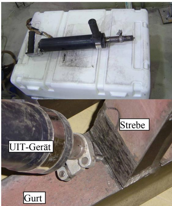
Bild 5. Schweißnahtnachbehandlung mit der UIT-Methode
