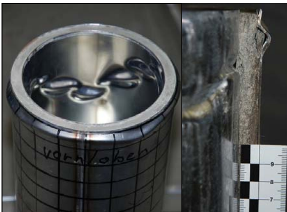
Bild 14. Knittereffekt beim SGS Fig. 14. Face wrinkling of SGS
