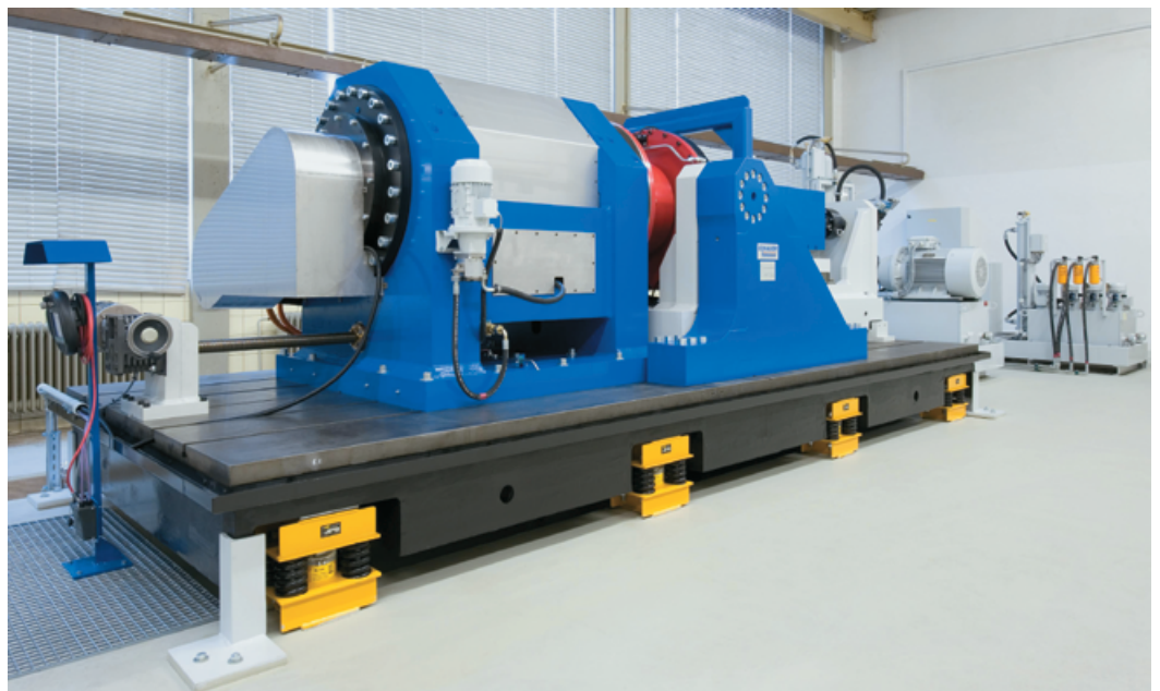
Abbildung 5 Großwälzlagerprüfstand Quelle: Eilhauer Maschinenbau GmbH
